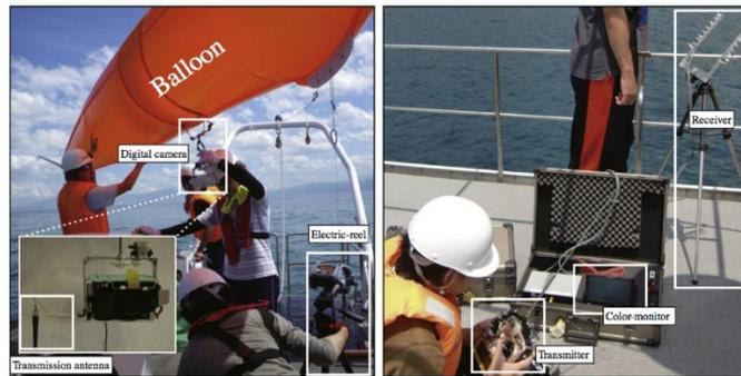
図1 バルーン空撮システム。左図において、船上から空に掲げるバルーンと高度を上げ下げする電動リール。そして赤外カメラを搭載したカメラユニット。右図はバルーンに搭載されたカメラからの映像を見ながら操作する。モニタ、コントローラ、アンテナを示す。
