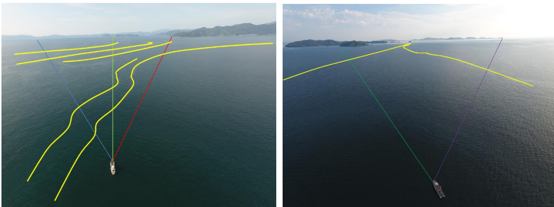
図2 ドローン空撮によって捉えられた海面の筋目(黄線で強調している). (左) 16時における北方撮影図. (右) 17時における南方撮影図. 図中の青・黄緑・赤・緑・紫の実線は定点と沿岸地形間の位置関係を示す(図1下図).
