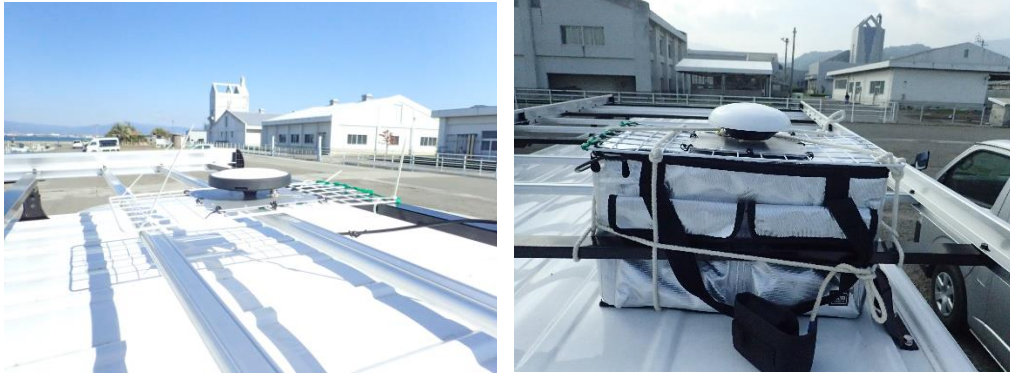
図 1 停車中のルーフ部分に設置した、参照用の GNSS 地上局 (左)。昨年度は夏季のため、ルーフの上に冷却材を設置した (右)。
