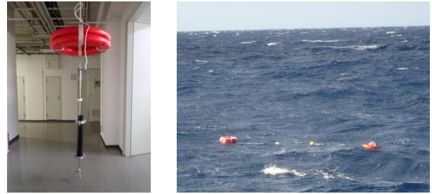
写真 1：左：Vector ブイの全景．右：豊後水道における観測時の Vector ブイ（左）と GPS 波浪ブイ（右）
