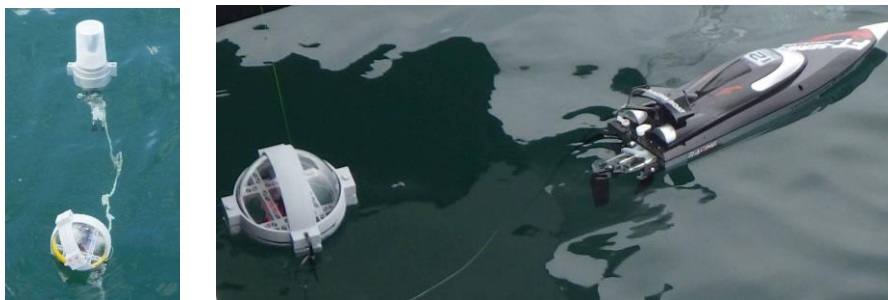
図 2 球形と円筒形の GNSS 浮体用センサー (左)。球形浮体はボートに曳航させ (右)，円筒形は Spray+ドローン上端に設置する。
