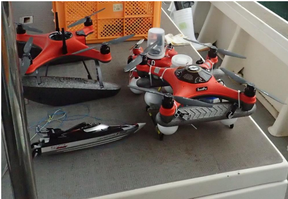
図 1 今回使用した観測プラットフォーム。Swellpro 社製防水ドローン：SprashDrone4 (左上)，SprashDrone 3+ (右下)，Spray+ (右上)。ラジコンボート (左下)。
