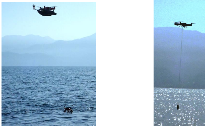
図 1 (左) 海面高度計測用のドローンと、海面で採水中の採水用ドローン。(右) 上空で待機中の、CTD センサーをロープで吊り下げたドローン。
