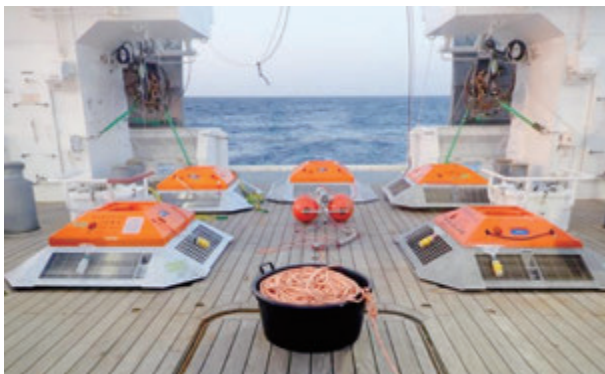
図1. 東シナ海における係留観測に投入した5台の海底設置型超音波式流速計 (TRBM-ADCP)。
