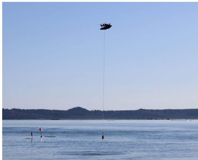
図 1 約 5m のロープで CTD センサーを吊り 下げた防水ドローン
